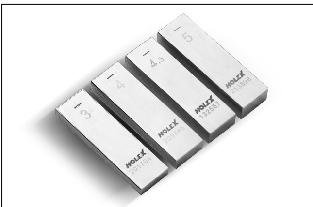
Satz Lehren zur Überprüfung des Wegaufnehmers
