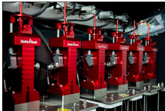
Messtation mit hochgenauer digitaler Wegmessung
